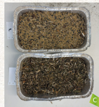
A = Faucheuse-andaineuse. B = Andain de lentille-moutarde. C = Échantillons issus de moisson en fauche-andainage (C - haut) et en direct (C - bas).
