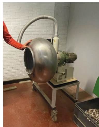
Figure 5. Enrobeuse du Centre Technique Horticole. Le tambour de la machine mesure 70 cm de diamètre.
