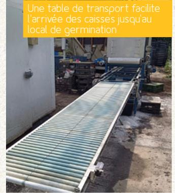
Une table de transport facilite l'arrivée des caisses jusqu'au local de germination
