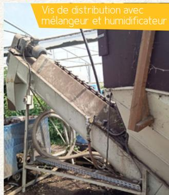
Vis de distribution avec mélangeur et humidificateur
