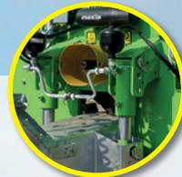
Suspension hydraulique du timon en standard
