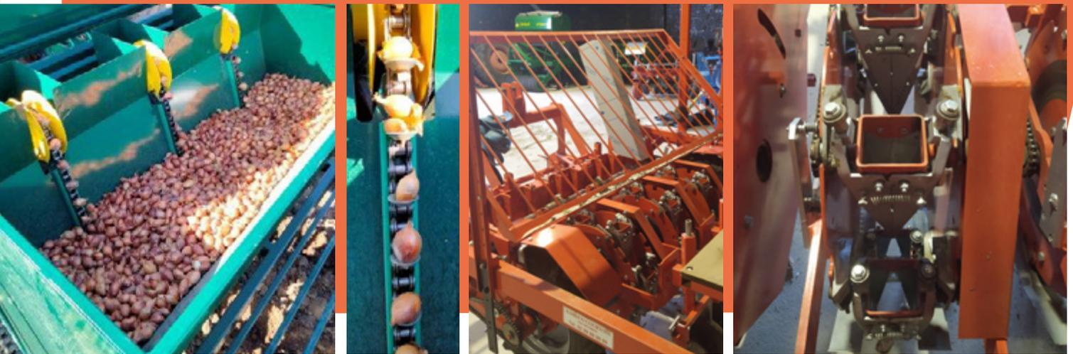
Figure 2 : Photographies de planteuse à bulbilles (à gauche) et de planteuse à mottes (à droite)
