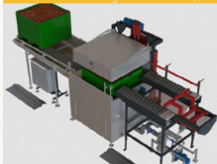
Unité de traitement d'eau chaude pour les fruits (source : www.burgmachinefabriek.nl )
