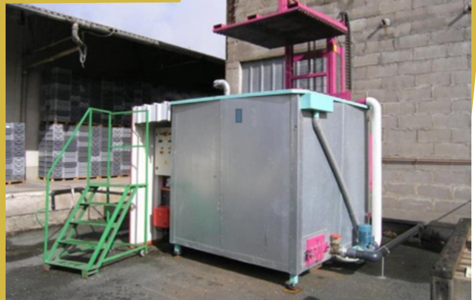
Exemple de cuve pour le trempage de palox dans l'eau chaude
