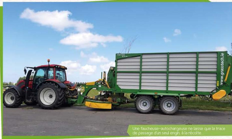
Une faucheuse-autochargeuse ne laisse que la trace de passage d'un seul engin, à la récolte.
