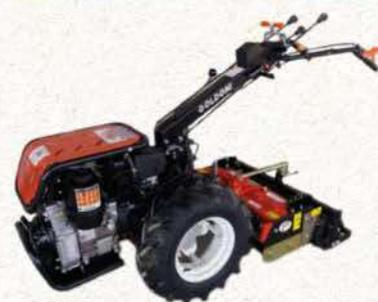
Les herse rotatives peuvent être accouplées directement avec un décompacteur à l'avant ou simplement un semoir ou une planteuse à l'arrière.
