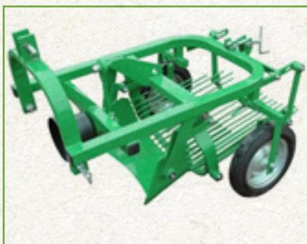
Arracheuse aligneuse 2 rangs
