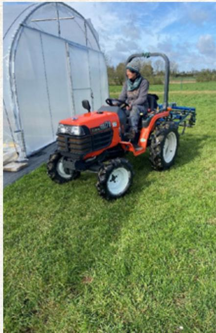
Cependant, des critères spécifiques ont été demandés à l'achat, par exemple une voie entre roues de 80 cm (pour cultiver sur des planches permanentes, le passage de roues servant de passe-pied). Le microtracteur a été acheté d'occasion, simple d'utilisation, reconditionné, sans électronique et d'une puissance de 21 CV minimum, afin de pouvoir y atteler un broyeur à fléaux, un broyeur de branches, une bennette et un vibroculteur de la largeur de la planche de culture.
