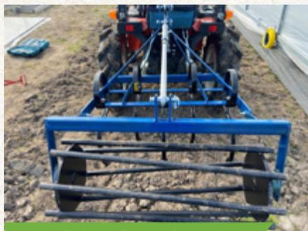
Vue sur le vibroculteur et la voie entre les roues du tracteur
