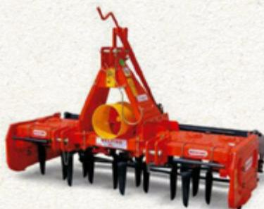
Chaque rotor tourne en sens opposé de son voisin, décalé d'un quart de tour, de manière à exploiter au mieux les effets de chocs sur les mottes et à assurer la bonne répartition latérale de la terre travaillée. Des panneaux latéraux en tôle font écran aux projections et permettent de mieux raccorder l'aspect de surface des passages successifs.
