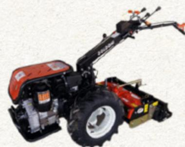
Les herses rotatives peuvent être accouplées directement avec un décompacteur à l'avant ou simplement un semoir ou une planteuse à l'arrière.
