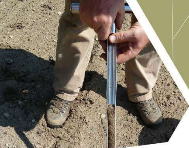
Échantillonnage à la tarière gouge (source : agumass.edu)
