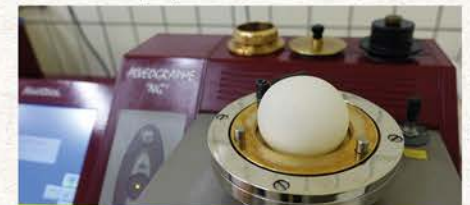
Formation du réseau de gluten-amidon à l'alvéographe de Chopin permettant d'évaluer la force du gluten (W) ainsi que sa ténacité (P), son extensibilité (L) et son élasticité (le)
