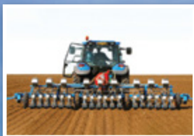
Semoir à légumes : possibilité de semis en planches ou en buttes
