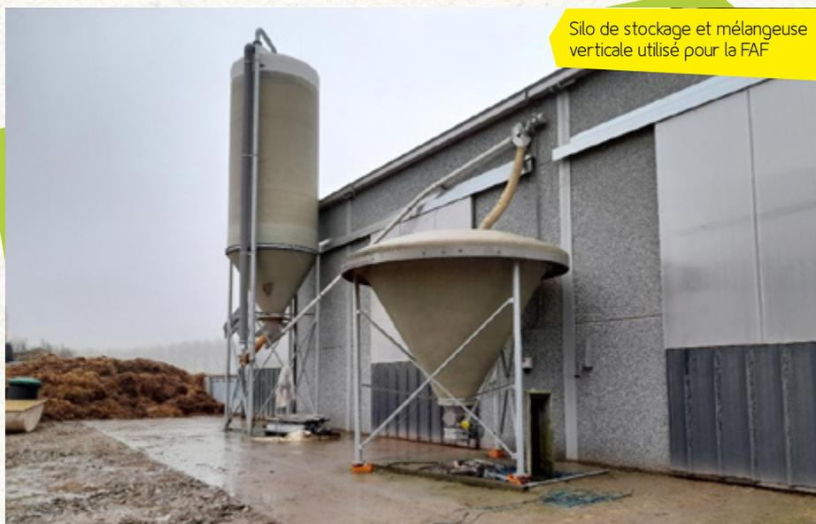
Silo de stockage et mélangeuse verticale utilisé pour la FAF
