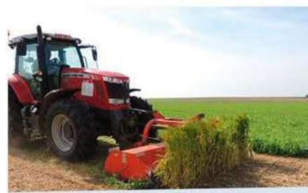
Broyeur à marteaux, broyé non incorporé (BNI)
