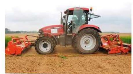
Broyeur à marteaux avec herse rotative, broyé incorporé (BI)
