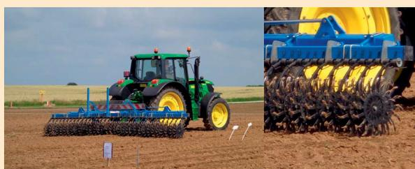
Houe rotative et élément de Houe rotative
