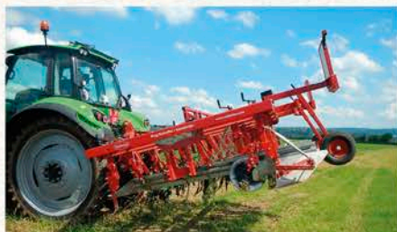
La sarco-butteuse de Steketee permet d'intervenir quand les pommes de terre sont déjà bien développées, grâce à un « guide et protège fanes »
