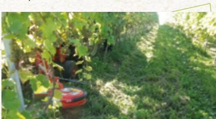
Dans les rangs, on travaille avec l'interceps, qui ne doit pas abîmer les pieds de vigne. Dans des sols légers ou caillouteux, des lames bineuses sont souvent utilisées. D'autres outils sont utilisés sur des sols lourds ou compactés. Parfois, sont utilisés des disques qui sectionnent le gazon venant de l'enherbement de l'inter-rang.
