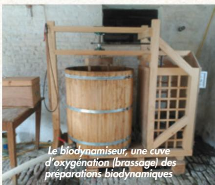
Le biodynamiseur, une cuve d'oxygénation (brassage) des préparations biodynamiques
