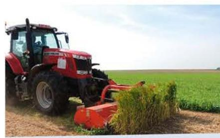
Broyeur à marteaux,broyé non incorporé (BNI)
