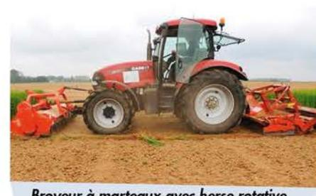
Broyeur à marteaux avec herse rotative, broyé incorporé (BI)
