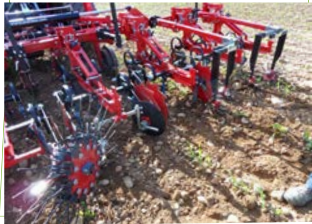
Exemple désherbage Tech&bio 2015 herse étrille - houe rotative - bineuse
