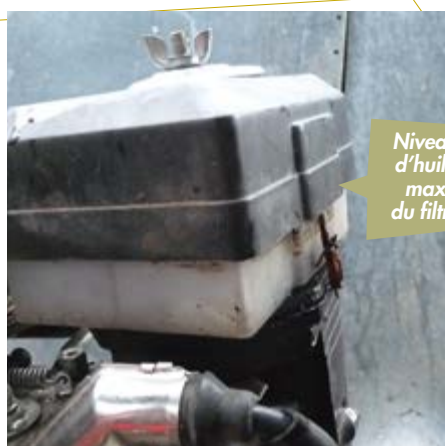
Filtre à air de motoculteur, ici à bain d'huile © Labye, T.
