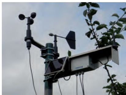
Fig. 5.6 : Une station météorologique située dans le verger permet de connaître heure par heure les conditions climatiques favorables à l'apparition d'infections. Ces conditions climatiques peuvent être très différentes d'un verger à l'autre.
