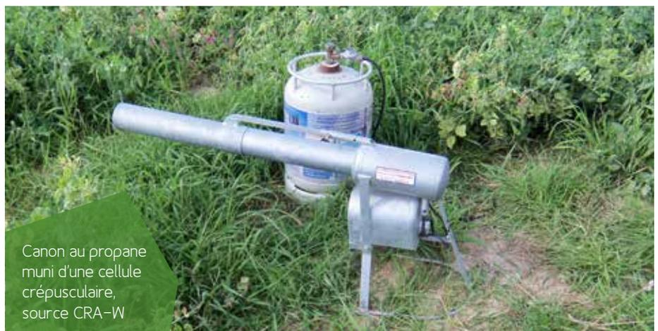
Canon au propane muni d'une cellule crépusculaire, source CRA-W
